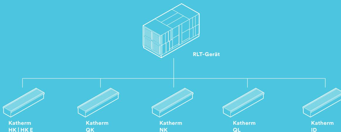
Nahezu alle Katherm Unterflurkonvektoren können im Projektfall mit einer Zuluftfunktion ausgestattet werden. Mit Hilfe von verschiedenen Zuluftstützenvarianten kann durch ein zentrales Lüftungsgerät
