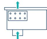
Mit Luftführung über den Konvektor und Lochblech unterhalb des Konvektors.
