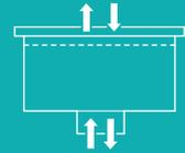
Für alle Kanalvarianten können auch Leerkänaile mit Zuluftstutzen in andere Unterflurvarianten integriert werden um Zuluft einzubringen. Alternativ können diese Kanäle auch als reine Abluftkanäle verwendet werden.
