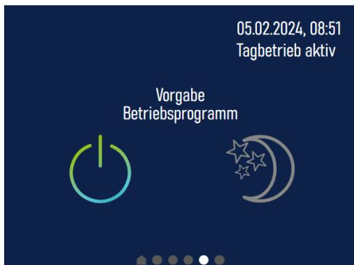
Über die Seite „Vorgabe Betriebsprogramm“ kann der Nutzer das gewünschte Betriebsprogramm (Aus, Tagbetrieb, Extrabetrieb, Ecobetrieb) vorgeben. Die Seite kann durch den Parameter „Freigabe manuelle Auswahl Betriebsprogramm“ ausgeblendet werden. Folgende Einstellungen sind möglich:
