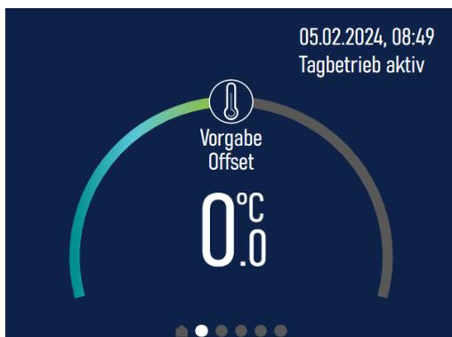
Über die Seite „Sollwertvorgabe Temperatur“ kann der Nutzer die gewünschte Raumtemperatur über einen Slider anpassen. Der eingestellte Wert wird im Slider angezeigt. Die Seite kann durch den Parameter „Freigabe manuelle Auswahl Temperatursollwert“ ausgeblendet werden. Folgende Einstellungen sind möglich:
