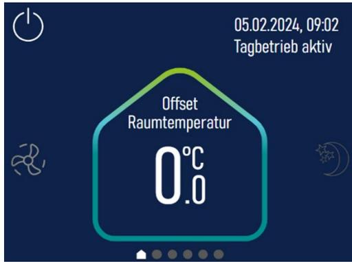
Die Übersichtsseite zeigt abhängig von der projekt- und gerätespezifischen Konfiguration Istwerte, Zustände und Sollwerte aus den Bereichen Temperaturregelung, Lüftersteuerung und Betriebsprogramm. Generell werden die aktuellen Zustände einer gesamten Gruppe angezeigt. Mit dem Parameter „Auswahl Geräte der Zone“ kann der Nutzer in der Hauptansicht auf ein individuelles Gerät zugreifen. Folgende Einstellungen sind möglich:
