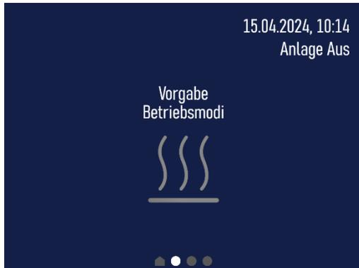
Über die Seite „Vorgabe Heizen für Türluftschleier“ kann der Nutzer den Heizbetrieb für den Tür-/Torluftschleier aktivieren. In diesem Fall wird das Heizsymbol aktiv dargestellt. Soll der Tür-/Torluftschleier lüften, kann der Heizbetrieb deaktiviert werden. Der Button wird inaktiv dargestellt. Die Seite kann durch den Parameter „Freigabe manuelle Auswahl Heizen Lüften TLS“ ausgeblendet werden. Folgende Einstellungen sind möglich:
