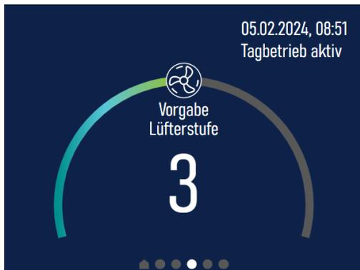
Über die Seite „Sollwertvorgabe Lüftersteuerung“ kann der Nutzer die gewünschte Lüfterstufe über einen Slider anpassen. Der eingestellte Wert wird im Slider angezeigt. Die Seite kann durch den Parameter „Freigabe manuelle Auswahl Lüfterstufe“ ausgeblendet werden. Folgende Einstellungen sind möglich:
