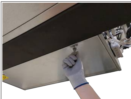
III. : 50: Ouvrir le verrou tournant
