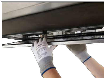
Ill. : 52: Pousser la tôle de protection
