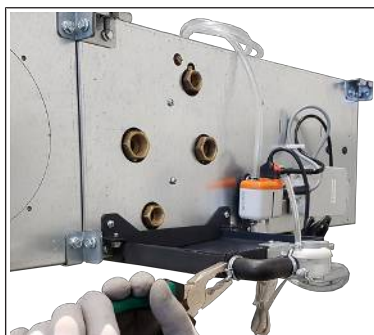
III. : 58: Desserrer le collier tendeur de fil
