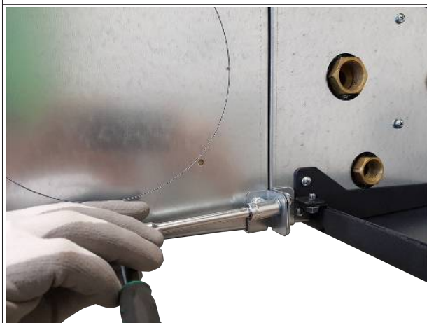
Ill. : 11: Serrer les vis à l'extérieur
