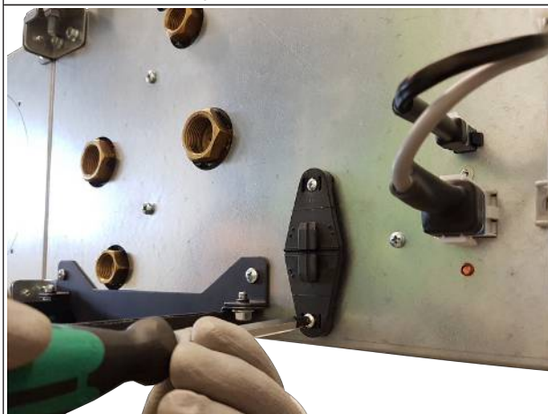
III. : 21: Monter le support pour pompe
