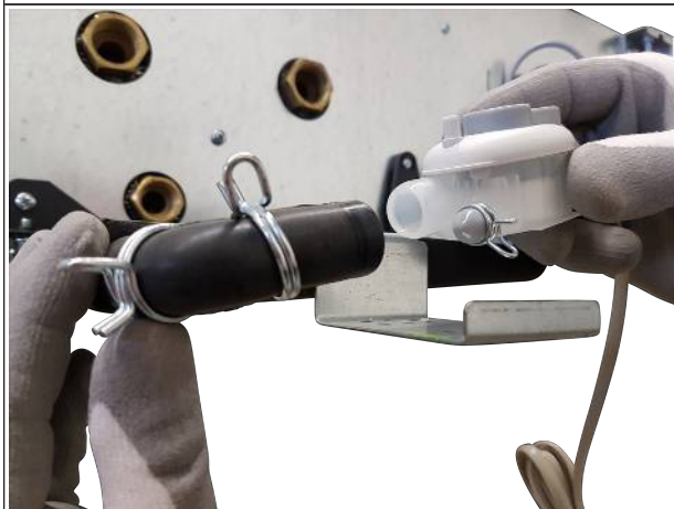
III. : 23: Enfoncer l'interrupteur à flotteur
