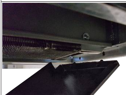
III. : 64: Monter le collecteur d'eau de condensation
