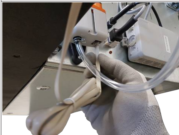
III. : 29: Enficher le câble de signalisation de l'interrupteur à flotteur
